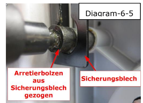
Arretierbolzen ganz aus Sicherungsblech gezogen. (6-5)
